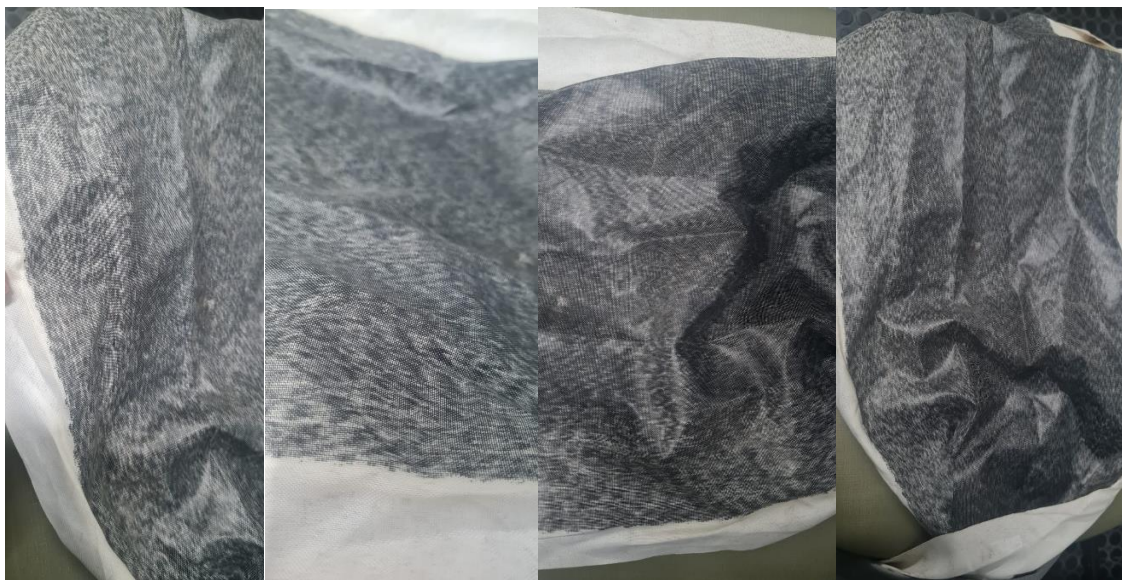
Figura 1 — Matéria-prima: resíduo de liner da recapagem de pneu em seu estado original.
