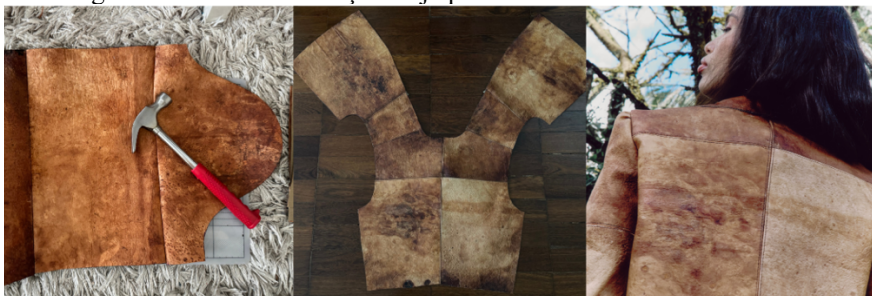
Figura 2: Processo de criação da jaqueta com material à base de micélio.
