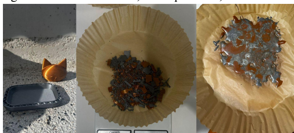
Figura 3- Resíduo de PLA, PLA quebrado, PLA derretido
